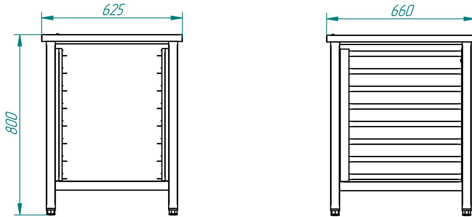
Подставка под конвекционные печи предназначена для использования на предприятиях общественного питания в качестве вспомогательного оборудования.
