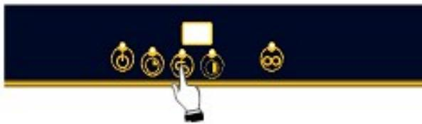
**Когда машина включена и танк для мытья полный, нажмите кнопку до тех пор, пока светодиодный индикатор начнет мигать и запустится цикл регенерации.** Откройте дверь, выньте сливной шланг, чтобы осушить танк и закройте дверь. Спустя 20 минут регенерационный цикл завершится и машина перейдет в режим ожидания. Откройте дверь, снова вставьте сливной шланг и закройте дверь. Отключите основной настенный выключатель.
