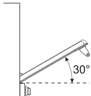
Для повторной установки вставить петли в специальные отверстия, имеющиеся в духовке, убедившись в том, что желобки **C** прислоняются полностью на отверстия. Опустить дверцу вниз и после ее установки вынуть стержни из отверстий петель.
