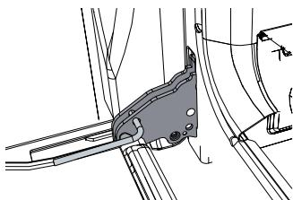
Взять дверцу за обе стороны двумя руками рядом с петлями, приподнять ее под углом приблизительно  $30^{\circ}$  и вынуть.
