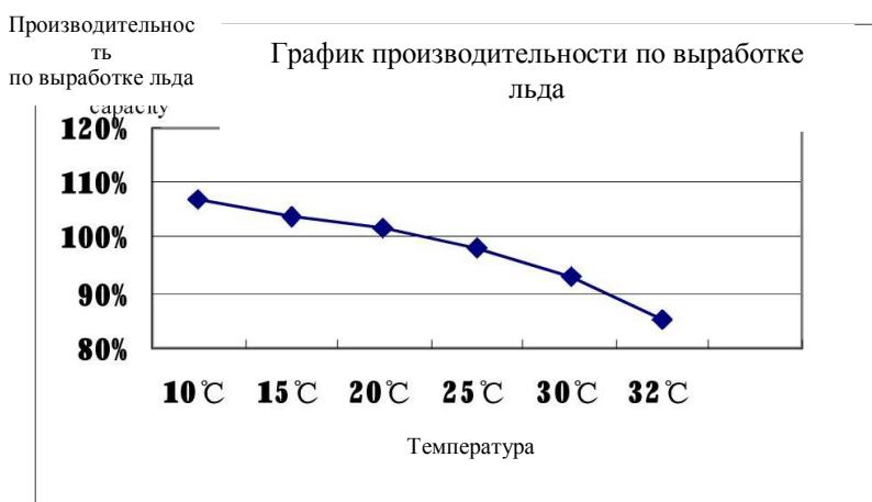
Примечание: В данном графике отображены фактическая производительность по выработке льда для воды 15 °C; в то время, как температуры воды увеличивается, производительность по выработке льда снижается.
